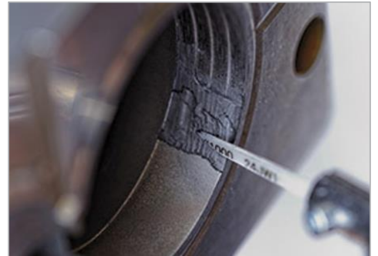
Detail des Scheinwerferpolierens für die Automobilindustrie
