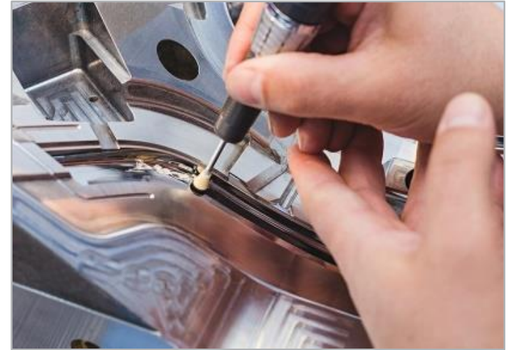
Detail des Scheinwerferpolierens für die Automobilindustrie
