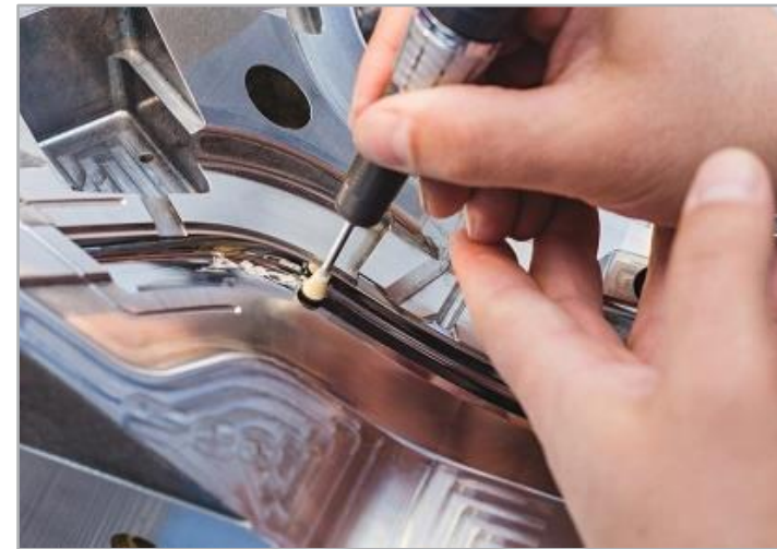
Detail beim Polieren des Scheinwerfers für die Automobilindustrie
